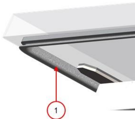
Schéma 16: Remplacement du joint du couvercle
