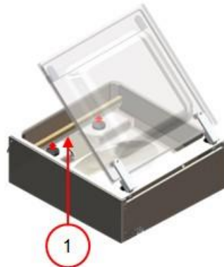
Schéma 13: Retrait de la barre de soudure
