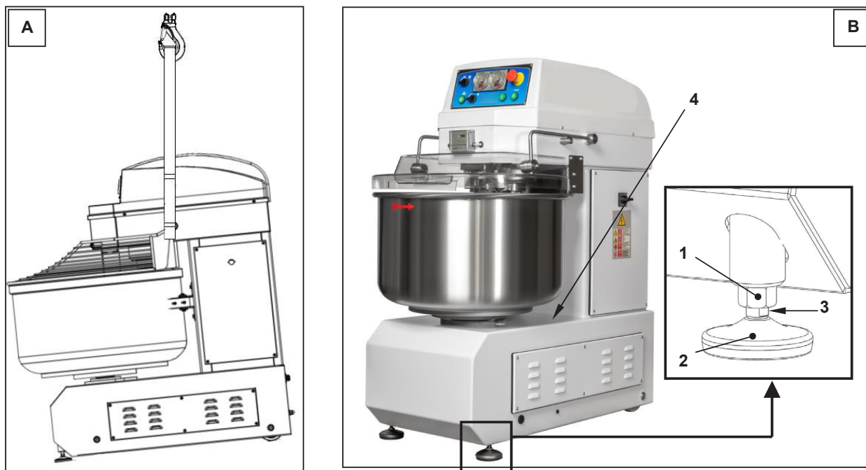
Figure 10 - Levage de la machine à l'aide d'une sangle et réglage des pieds de support au sol
