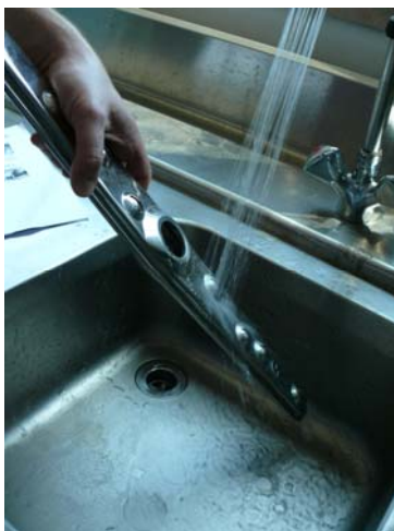
Nettoyez le tourniquet de lavage. Vérifiez la présence de débris à son intérieur.
