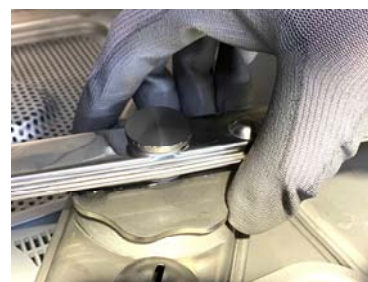
Agir sur le „grande“ écrou pour dévisser le bras de rinçage.
