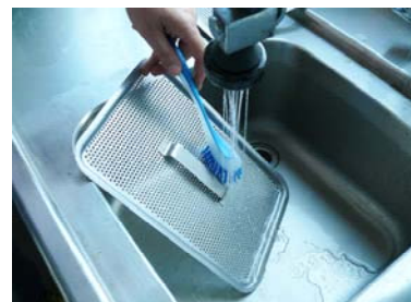
Nettoyez les filtres de la cuve
