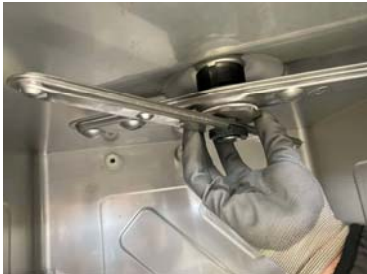
Dévissez le tourniquet de rinçage supérieur toujours en agissant sur l'écrou la plus grande
