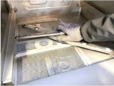
Démonter le bras de rinçage inférieur en agissant sur le "grande" écrou
