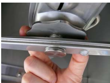
Dévissez le tourniquet de rinçage supérieur
