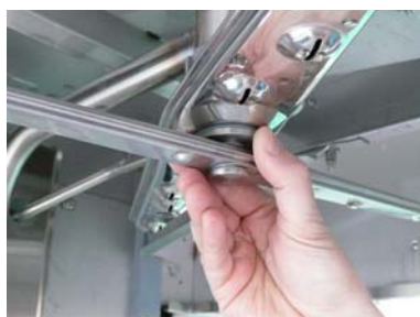
Dévissez le tourniquet de rinçage supérieur
