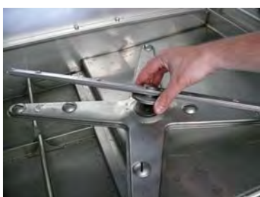
Vissez le bras de rinçage inférieur
