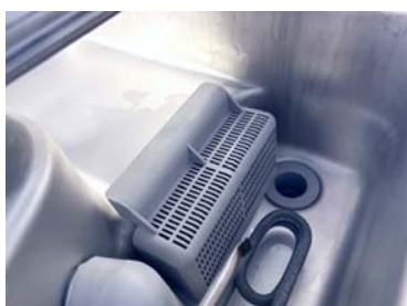
Verifiez que le filter aspiration pompe soit dans sa siège.
