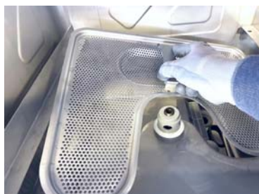
Insérez le filtre de la cuve dans son endroit.
