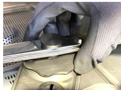
Agir sur le „grande“ écrou pour dévisser le bras de rinçage.
