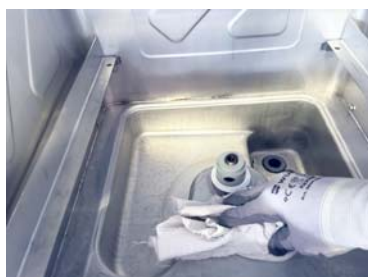
Nettoyez la cuve et vérifiez tous les débris sur le fond .
