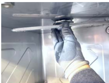
Dévissez le tourniquet de rinçage supérieur toujours en agissant sur liécrou la plus grande
