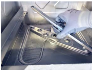
Démonter le bras de rinçage inférieur en agissant sur le "grande" écrou
