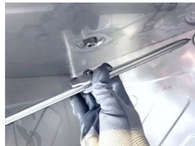
Agir sur le „grande“ écrou pour dévisser le bras de rinçage.
